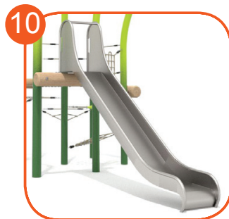
10 Liuku ruostumattomasta teräksestä AISI 304. Reunan paksuus 2 mm ja pyöristysputki 33,7 mm.
