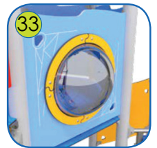
33 Puolipalloikkuna halkaisija 400 mm. Materiaali: 5 mm paksua kuumapuristettua polykarbonaattia.
