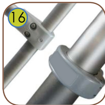
16 Kiinnike ja puristinosat tehty vahvasta alumiiniseoksesta. Alumiini on vahvistettu elektroforeesimenetelmällä ja polyesterijauhemaalikerroksella. QUALICOAT hyväksytty.
