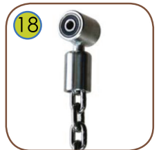
18 Keinujen kannattimet, tuplalaakereilla ruostumattomasta teräksestä takaa hiljaisen toimintamekanismin. Vaakaliikkeen lisäksi mahdollistaa myös pyöreän liikkeen ilman ketjujen kiertymistä.
