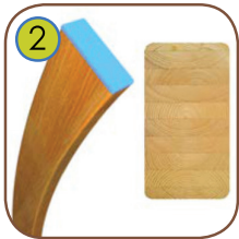
2 Taivutetut talpat männystä, paksuus 9 cm, leveys 26 cm ja pituus 280 cm. Puu on ytimetön, liimattu kerroksittain polyuretaaniliimalla. Täysin veden kestävä. Puu suojattu säälöihin kyllästämällä kahdesti puunsuojakyllästeellä.
