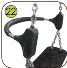
22 Istuimen selkätuki teräs-rakenteella, suojattu pehmeällä polyuretaanilla. Pääteosat tehty polyamidista.
